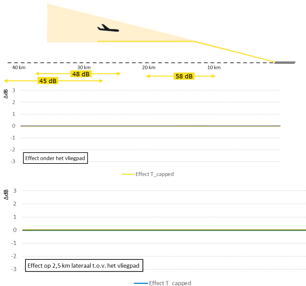
Figuur 0-7 Geluideffecten als gevolg van een extrapolatielimiet, ten opzichte van de standaard situatie waarbij geen limiet wordt toegepast.
